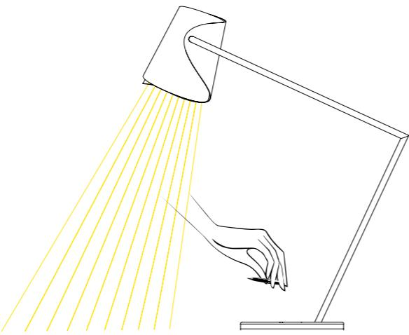
Lo strumento da scrittura, sollevato sfiorando l'alloggio in pelle, permette l'accensione del LED all'interno del diffusore.
